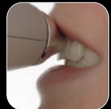
Falsche Messposition zum Zahn – Instrument ist geneigt und ermöglicht seitlichen Einfall von Umgebungslicht
