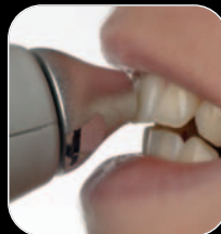
Falsche Messposition zum Zahn – Instrument ist geneigt und ermöglicht seitlichen Einfall von Umgebungslicht
