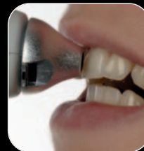
Falsche Messposition zum Zahn – Instrument ist geneigt und ermöglicht seitlichen Einfall von Umgebungslicht
