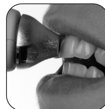
Falsche Messposition zum Zahn – Instrument ist geneigt und ermöglicht seitlichen Einfall von Umgebungslicht. Incorrect positioning on the tooth – instrument tilted away from tooth allowing ambient light into measurement.
