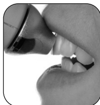
Falsche Messposition zum Zahn – Instrument ist geneigt und ermöglicht seitlichen Einfall von Umgebungslicht. Incorrect positioning on the tooth – instrument tilted away from tooth allowing ambient light into measurement.
