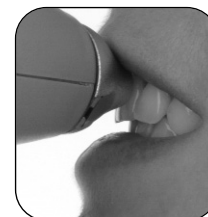
Falsche Messposition zum Zahn – Instrument ist geneigt und ermöglicht seitlichen Einfall von Umgebungslicht. Incorrect positioning on the tooth – instrument tilted away from tooth allowing ambient light into measurement.
